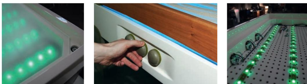
Im Inneren des Lumocube sind SMD RGB 3-in-1 Flex LEDs so unter einer Diffusor-Platte angeordnet, dass eine absolut homogene und spotfreie Leuchtfläche entsteht. Über die 3 drehbaren RGB-Bedienelemente lassen sich die Farben Rot, Grün und Blau separat und stufenlos ansteuern. Optional können wir den Lumocube auch mit leistungsstärkeren SMDs, RGBW, RGBAW oder DMX Steuerung (Steuerung über externe Geräte) ausstatten.
